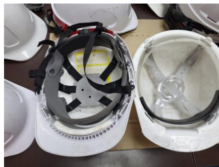
Fuente: Cascos con y sin barboquejo verificados durante la prueba.
