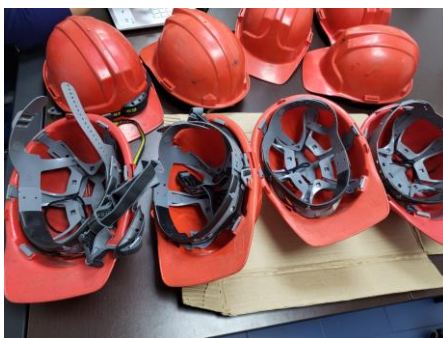
Fuente: Cascos con y sin barboquejo verificados durante la prueba.
